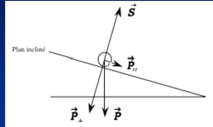
Un plan incliné décompose la force de la pesanteur verticale  $\mathbf{P}$  en deux parties,  $\mathbf{P}_{\parallel}$  (parallèle) et  $\mathbf{P}_{\perp}$  (perpendiculaire). C'est la partie parallèle uniquement qui agit en provoquant le mouvement de la bille. Elle peut être réduite à volonté.
