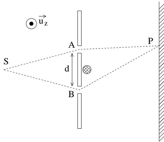
Figure 1: Expérience de principe pour mettre en évidence l'effet Bohm-Aharonov.  $S$  représente la source d'électrons, le cercle hachuré schématise le solénoïde en coupe.
