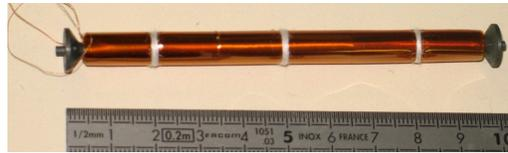
FIG. 1.1 – Prototype de capteur de champ magnétique.
