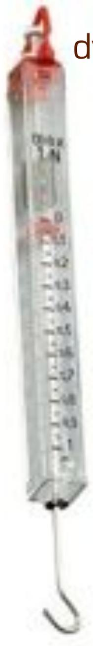
dynamomètre : un ressort étalonné
