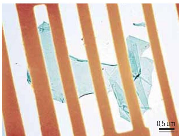
contacts électriques, afin de mesurer les propriétés électriques du graphène.
